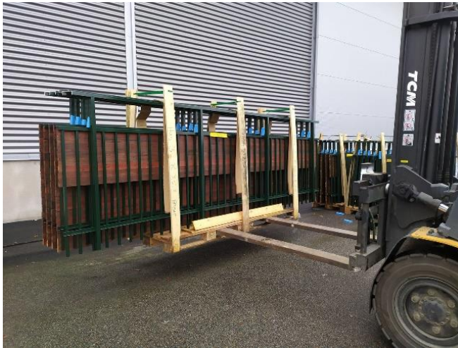
Bild 1. Räcken kommer packade på lastbärare som är balanserad. Lyft från långsidan med vanligt gaffelstativ med gafflarna så brett isär som möjligt.
