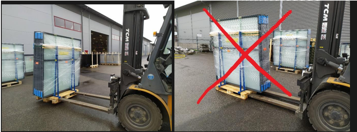
Bild 3. Lyfts med vanligt gaffelstativ med gafflarna så brett isär som möjligt. OBS! hanteras endast från långsidan!
