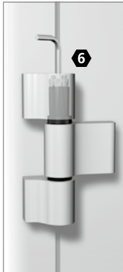
Vrid lagerhylsan \pm 90^\circ tills den kommer i sitt läge. (Tätningstryck \pm 0,5 mm).
