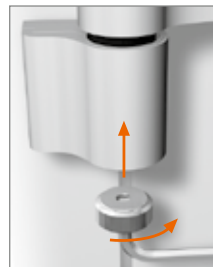
Positionera medbringaren i den övre karm gångjärns delendelen.
